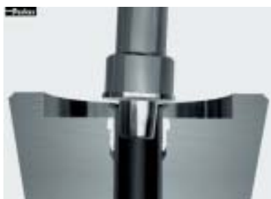
Tan pronto como la superficie de trabajo plana del punzón hace contacto con el extremo del tubo, comienza el proceso de embriado
