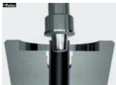
Mientras se mueve, el punzón delantero expande la pared del tubo desde el interior
