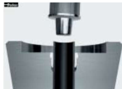
Después de comenzar el proceso, las mordazas sujetan el tubo y el punzón de embriar inicia el movimiento orbital y la carrera hacia delante
