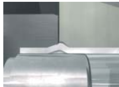
El contorno interior también se deforma ligeramente, pero permanece liso y sin restricciones para unas buenas características de flujo
