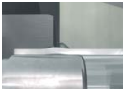
Mientras se mueve, el punzón forma continuamente la pared del tubo y comprime el material
