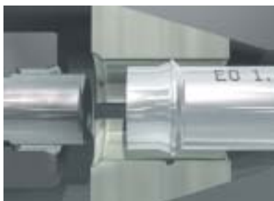
El extremo del tubo se libera y está listo para fijar la junta EO-2
