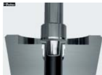
La superficie frontal se lamina y comprime continuamente. Desde el interior, la superficie del tubo se expande ligeramente para fijar la férula
